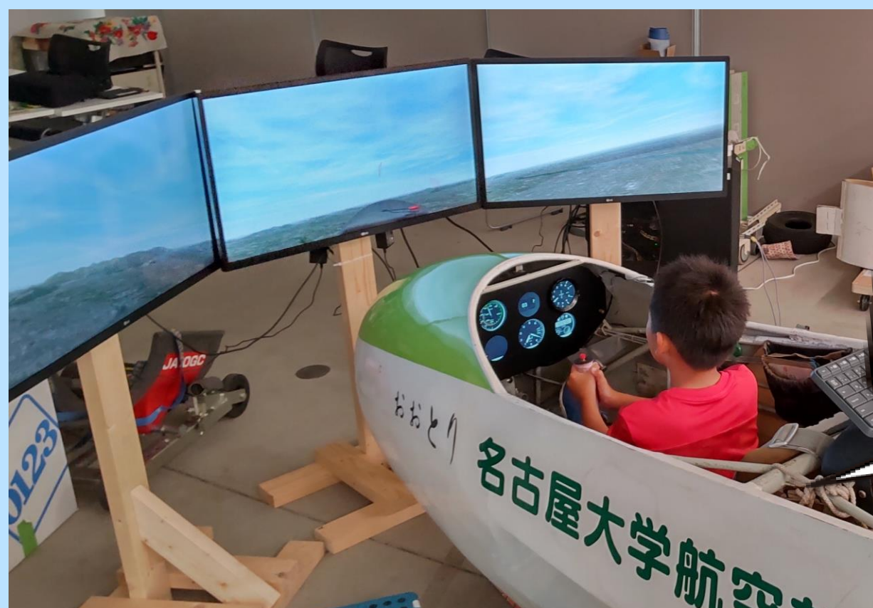
このフライトシミュレーターは、操縦訓練に使用した上級滑空機 JA2392 (アレキサンダー・シュライハー社ASK13) を利用し開発したフライトシミュレーターです。実機の練習機を使った世界でただひとつのグライダーシミュレーターです。
